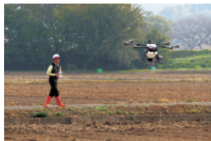
↑ドローン下部に専用の容器を取り付け、種もみを空中から散布します
